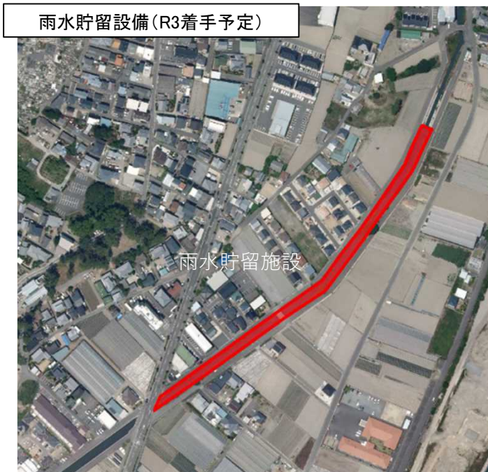
南沖洲地区雨水貯留施設整備
